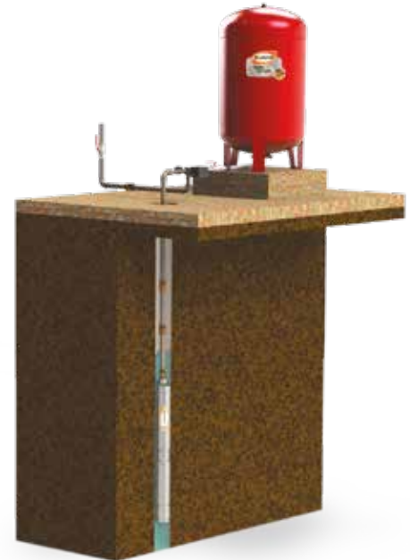
DIAGRAMA DE INSTALACIÓN PARA HIDRONEUMÁTICO
